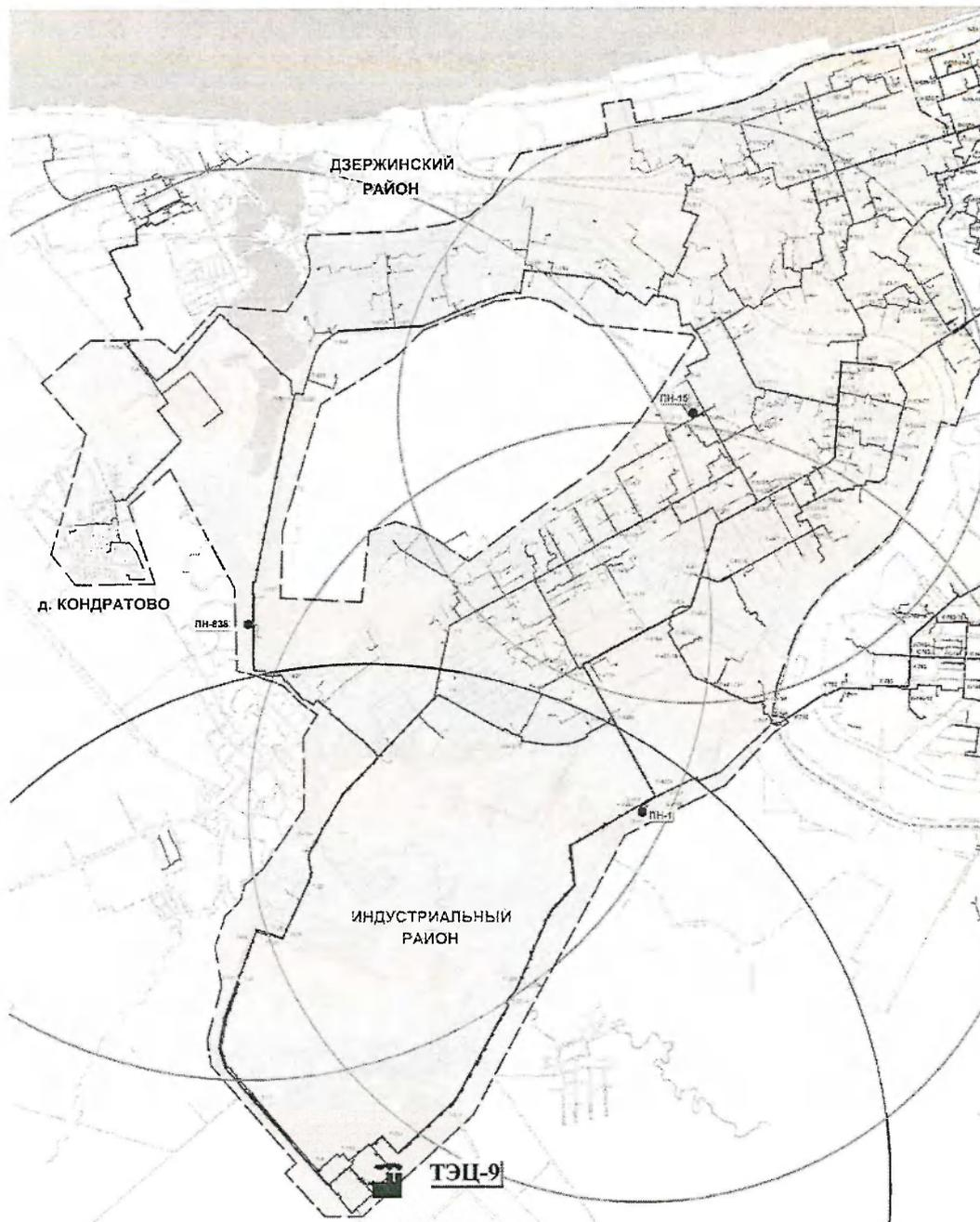
Рисунок - Схема тепловых зон и радиус эффективного теплоснабжения ТЭЦ-9
